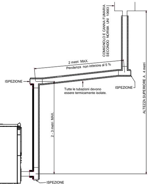
Ce qui est décrit ci-dessus est indispensable pour pouvoir éliminer la cendre et les substances imbrûlées qui éventuellement se déposent le long du conduit d'évacuation. L'appareil fonctionne avec la chambre de combustion en dépression, alors que la sortie des fumées à la cheminée présente une légère pression, par conséquent il est nécessaire de veiller à ce que le système d'évacuation soit hermétique.
