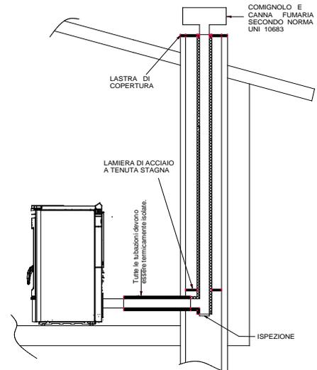
Toutes les parties du conduit des fumées devront pouvoir être vérifiées et démontées pour effectuer le nettoyage interne.
